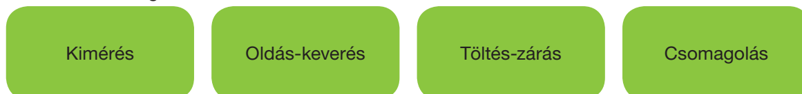
8. ábra Folyékony sportélelmiszerek gyártási lépései
