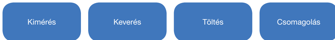
4. ábra Por és porkeverékek gyártási lépései
