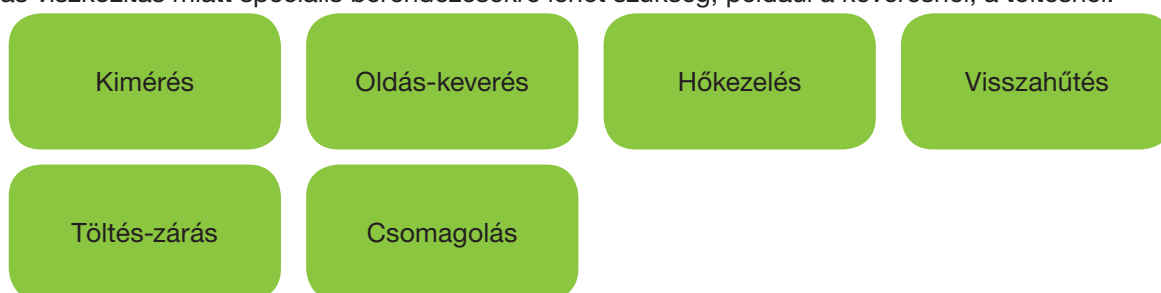
9. ábra Hőkezelést igénylő sportélelmiszerek gyártási lépései
